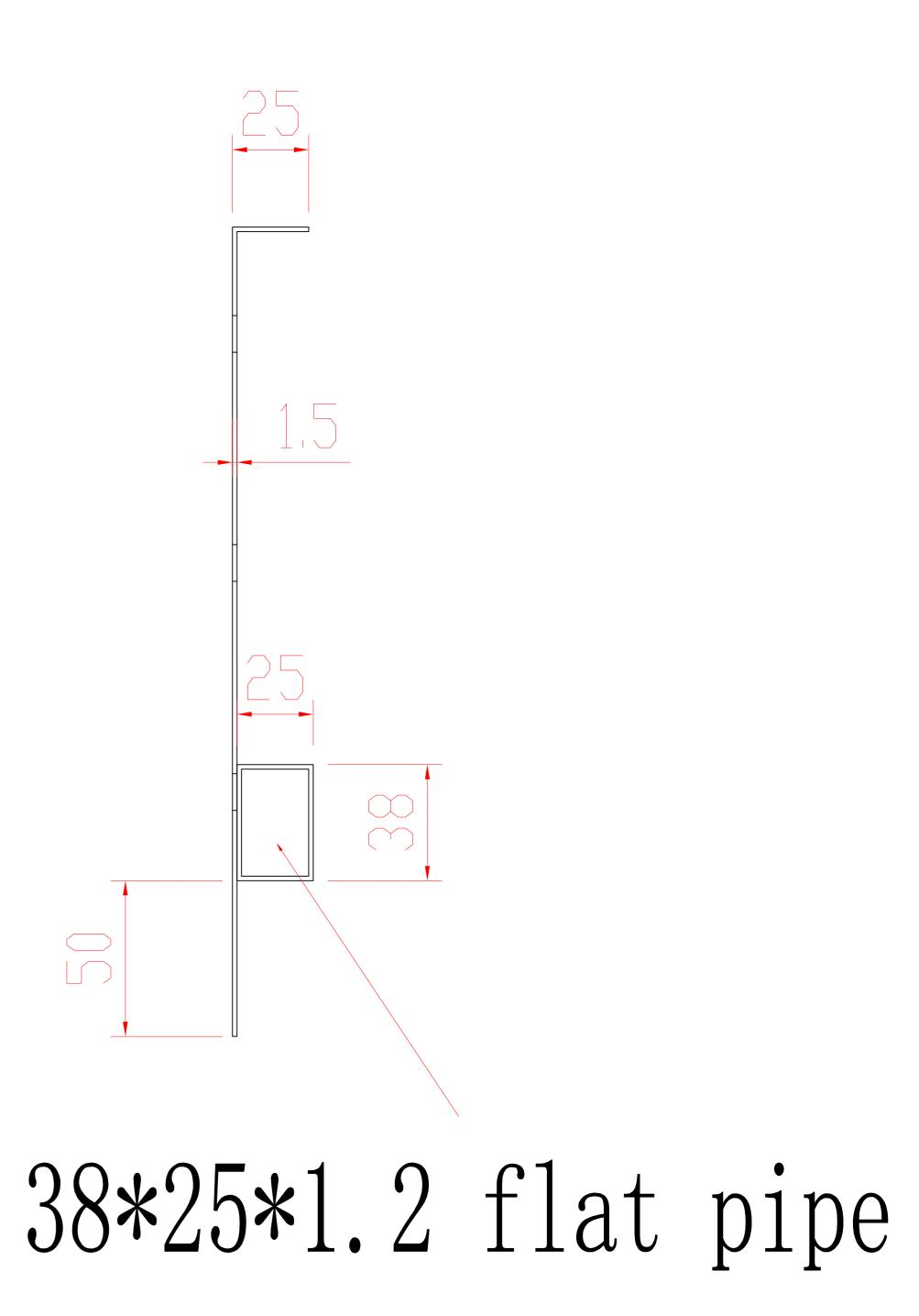
Guardrail baffle(reverse side)
